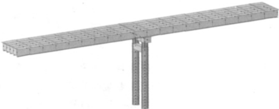
图 2 简支梁桥原设计方案分析模型
